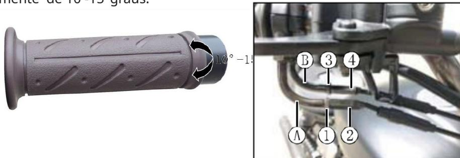
Cabos de aço do acelerador. (A) cabo de puxar do acelerador (B) cabo de empurrar do acelerador.
