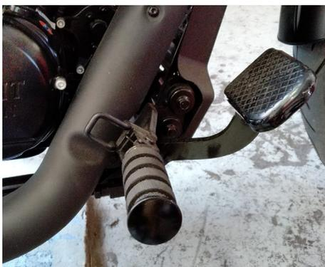
Deve pressionar este pedal para ativar o travão traseiro. A luz de travagem acende-se em simultâneo.
