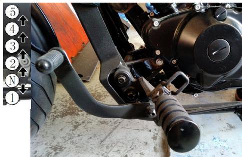
Este veículo está equipado com uma transmissão de 5 velocidades. O ponto neutro situa-se entre a primeira e a segunda velocidade. A partir de ponto neutro, baixe o seletor de mudanças para engrenar a primeira velocidade. Para mudar uma mudança, mova o seletor para cima. A passagem da segunda para a primeira é feita através do ponto morto.
