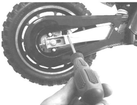
**Passo 1:** Use uma chave de estrela para desapertar os 3 parafusos e remova a protecção de corrente
