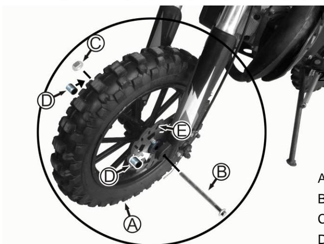
Coloque a roda (A) na posição correcta para colocar o disco (E) entre as pastilhas de travão.
