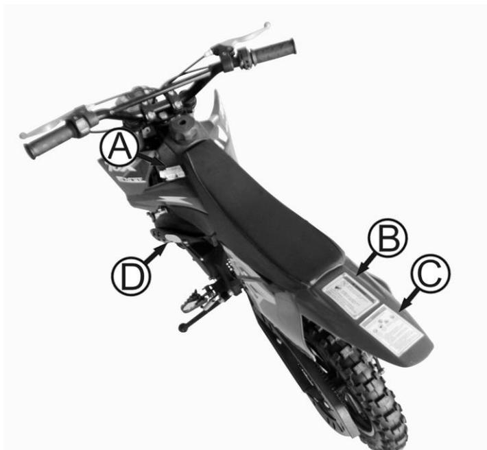
Autocolante A está localizado do lado esquerdo do depósito de combustível.
