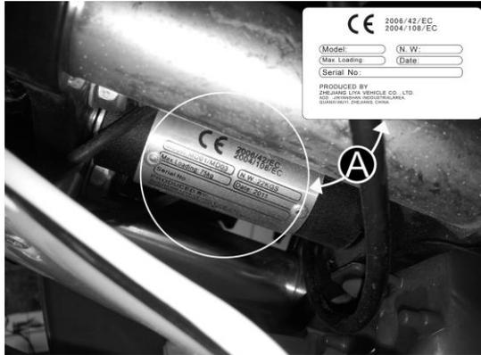
O PIN está gravado numa placa de alumínio localizada na coluna de direcção.
